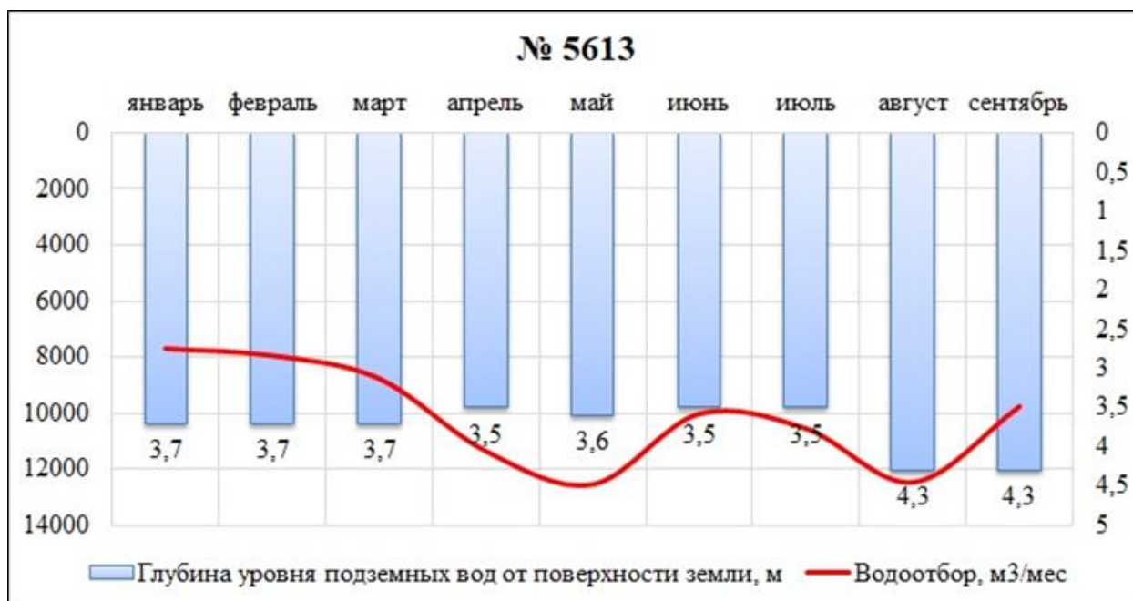
Рис. 1.11 Водоотбор и положение уровня ПВ на скважине ОНС в Верхнесадовском МО
