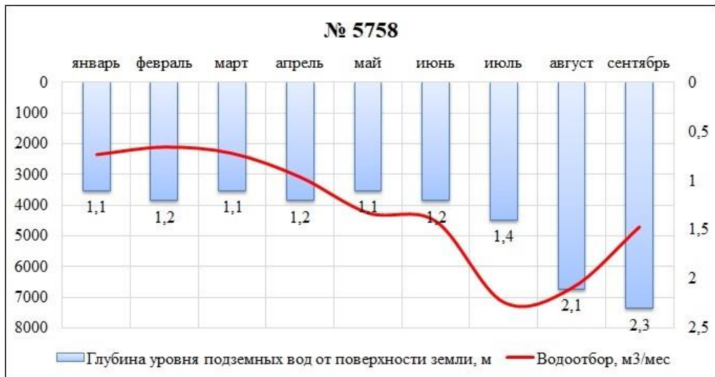
Рис. 1.17 Водоотбор и положение уровня ПВ на скважине ОНС Любимовского водозабора в Нахимовском МО
